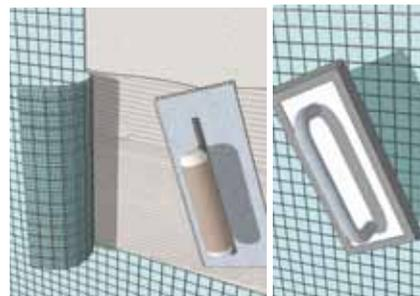
**STENDERE IL COLLANTE** *Il collante va preparato seguendo le indicazioni della scheda tecnica del produttore per ottenere un composto omogeneo e senza grumi. Deve essere applicato in modo uniforme con l'aiuto di una spatola.*
